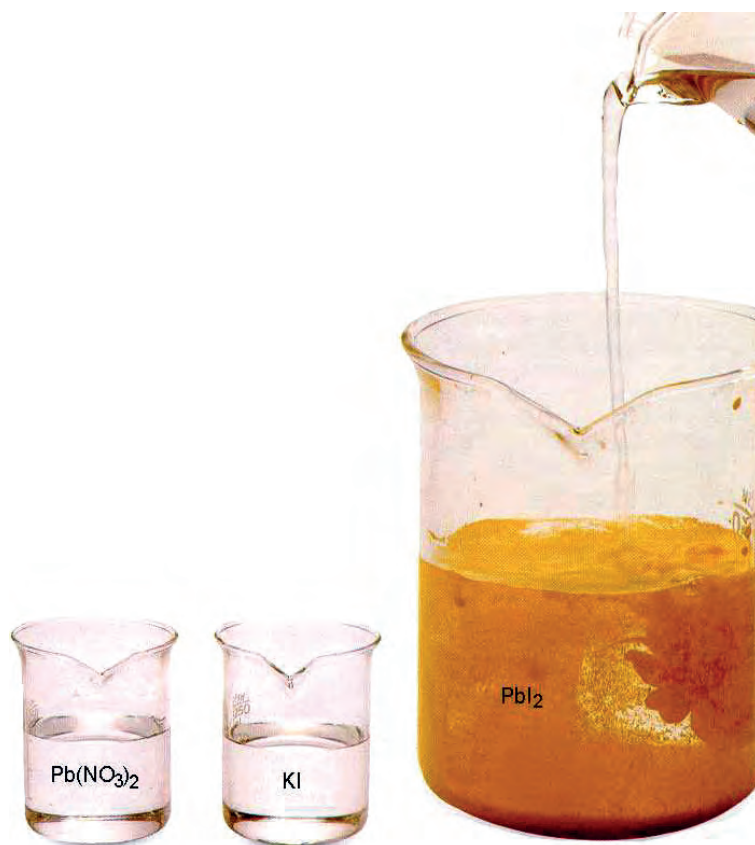
ΣΧΗΜΑ 3.9 Εικονική παρουσίαση της αντίδρασης διπλής αντικατάστασης μεταξύ Pb(NO 3 ) 2 και KI προς σχηματισμό του κίτρινου ιζήματος PbI 2 .
