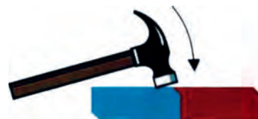
Απομαγνήτιση υλικού με κρούση.
