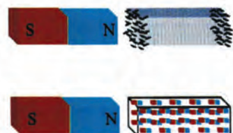
Μαγνήτιση με επαγωγή. Εικόνα 4.1-16.
