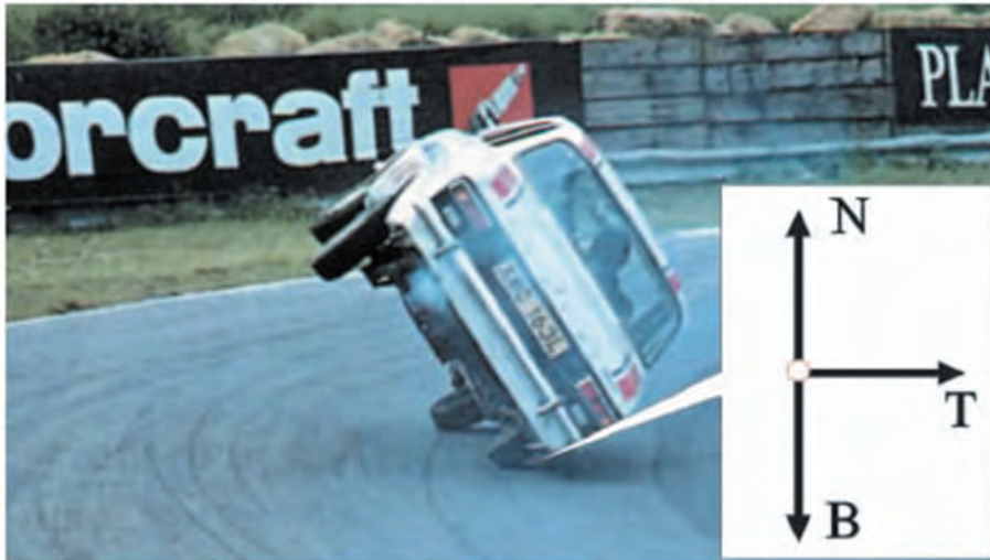
Το αυτοκίνητο κινείται στους δύο τροχούς, έχοντας εξασφαλίσει την απαραίτητη κεντρομόλο δύναμη.
