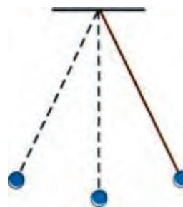
Το σφαιρίδιο πραγματοποιεί γραμμική αρμονική ταλάντωση. Εικόνα 5.1-6.
