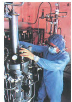
Εικόνα 7.3 α. Διαγραμματική απεικόνιση βιοαντιδραστήρα, όπου φαίνονται τα διάφορα τμήματά του, καθώς και οι συστασις αλλαγών των συνθηκών ζύμωσης β. Φωτογραφία βιοαντιδραστήρα.
