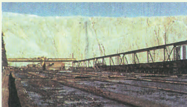
Εικόνα 10.8 Έκπλυση μεταλλευμάτων χαμηλής περιεκτικότητας σε Cu με τη χρήση του βακτηρίου Thiobacillus ferrooxidans . Από την κορυφή του σωρού διοχετεύεται νερό με \text{H}_2\text{SO}_4 που ξεπλένει το μέταλλευμα. Στο τέλος της διαδρομής το διάλυμα είναι πλούσιο σε Cu.
