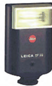
Εικ. 3.7 Η λειτουργία του φλας της φωτογραφικής μηχανής στηρίζεται στην εκφόρτιση ενός πυκνωτή δια μέσου μιας λυχνίας ξένου. Καθώς εκφορτίζεται ο πυκνωτής το αέριο ξένο ιονίζεται με αποτέλεσμα την έντονη αναλαμπή μικρής διάρκειας.
