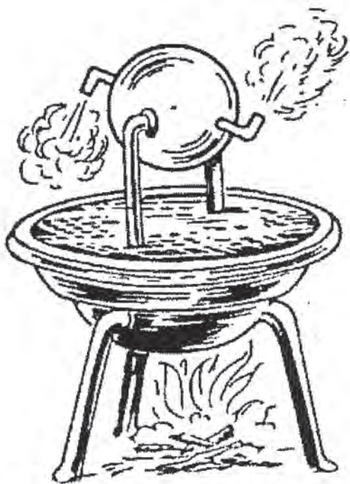
Εικ. 2.1 Σχέδιο του ατμοστρόβιλου που επινόησε ο αρχαίος Έλληνας εφευρέτης Ήρων (Αλεξάνδρεια, περ. 100 μ.Χ.). Το δοχείο είναι κλειστό και επικοινωνεί με τη σφαίρα με τους δύο κατακόρυφους σωλήνες. Με βρασμό νερού παράγεται ατμός στο δοχείο που εισέρχεται από τους σωλήνες στη σφαίρα και εξέρχεται με μεγάλη ταχύτητα από τα δύο ακροφύσια θέτοντας σε περιστροφή τη σφαίρα.
